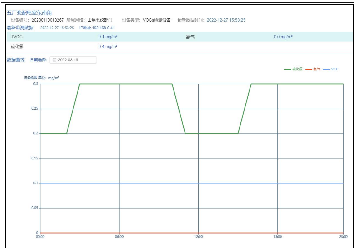
五厂变配电室东南角 VOCs 在线监测仪 2022 年 3 月 16 日 TVOCs 浓度分布曲线
