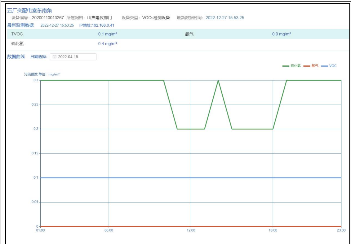
五厂变配电室东南角 VOCs 在线监测仪 2022 年 4 月 15 日 TVOCs 浓度分布曲线
