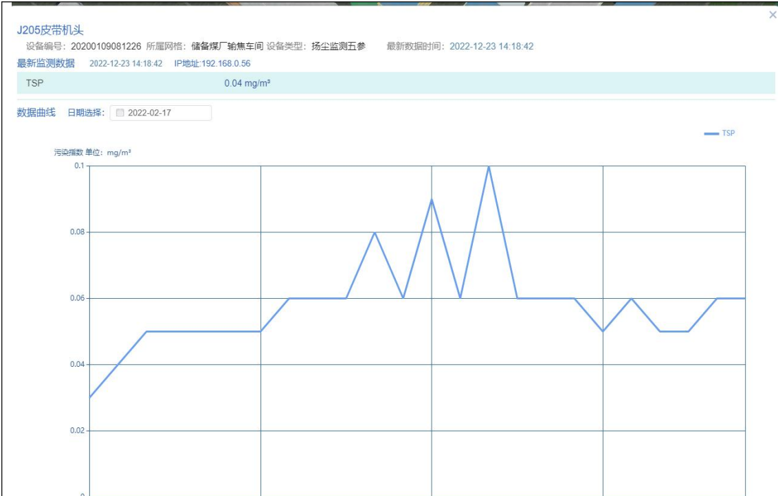
二系统输焦车间 J205 皮带 2022 年 2 月 17 日 TSP 浓度监测设备浓度曲线
