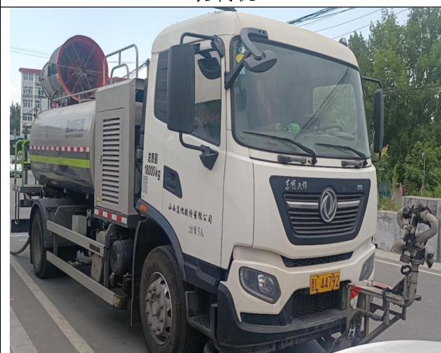
喷雾除尘机 8#车
