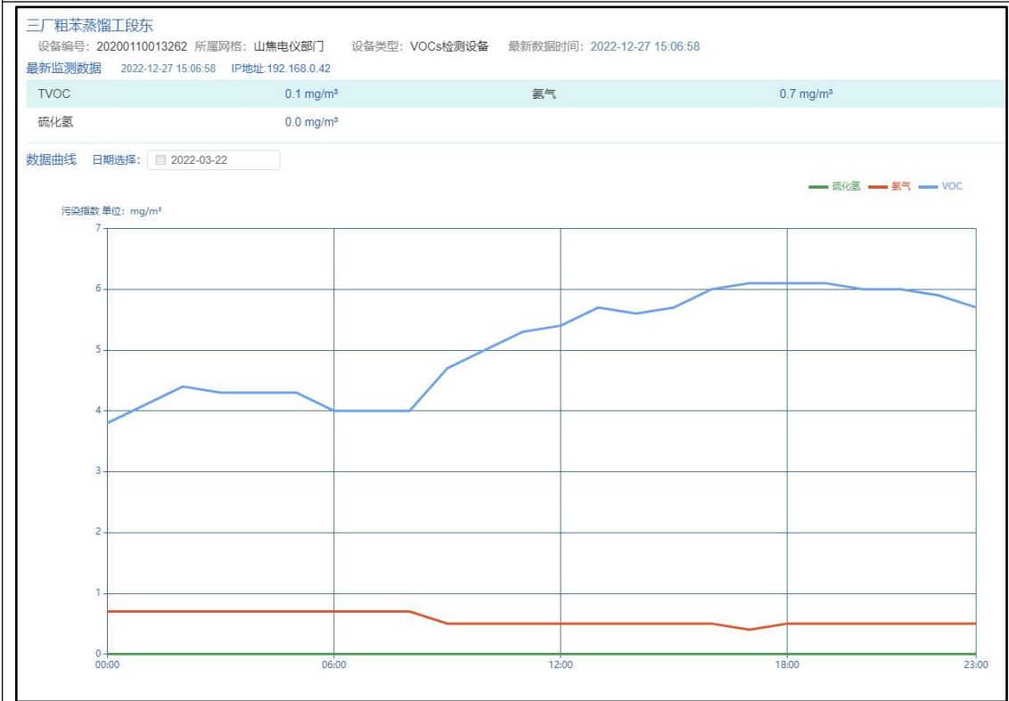
化产品回收厂三回收粗苯蒸馏工段东侧 VOCs 在线监测仪 2022 年 3 月 22 日 TVOCs 浓度分布曲线
