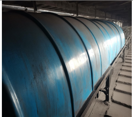
输焦皮带封闭 二系统输焦皮带 206 机尾集气罩
